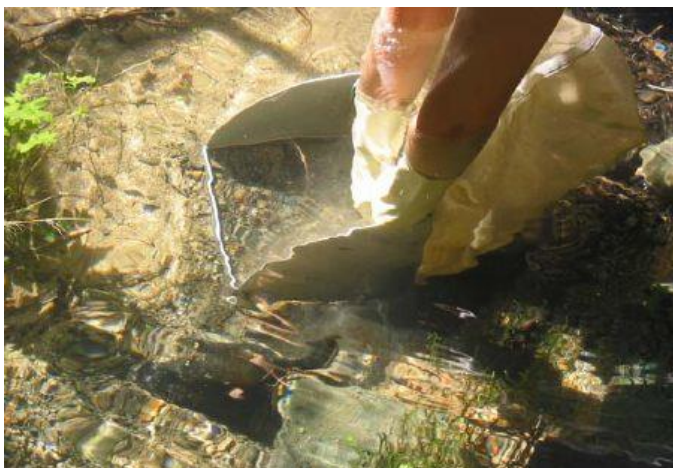
Figure 8 : Prélèvement d'invertébrés au filet Surber (source : www.lorraine.ecologie.gouv.fr )
